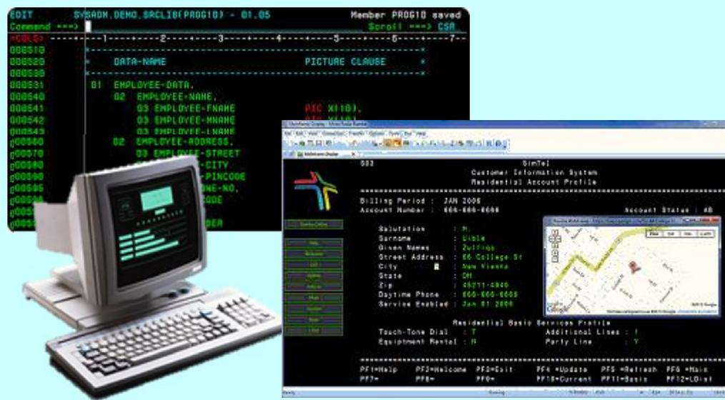
En estos terminales *no se realizaba ninguna tarea de proceso de datos*, solo servían para *conectar al usuario al 'mainframe'* a través del teclado y la pantalla.
