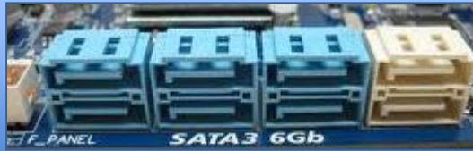
Conexiones SATA para discos duros o DVD/BluRay
