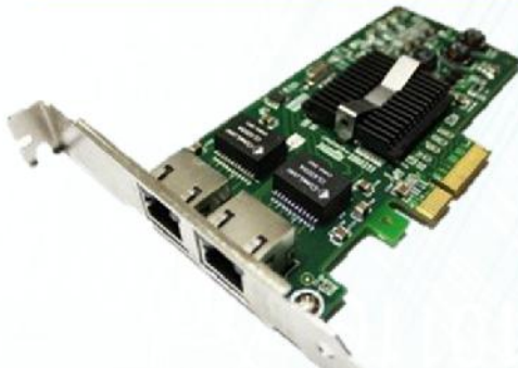
Dos conexiones RJ-45 UTP
